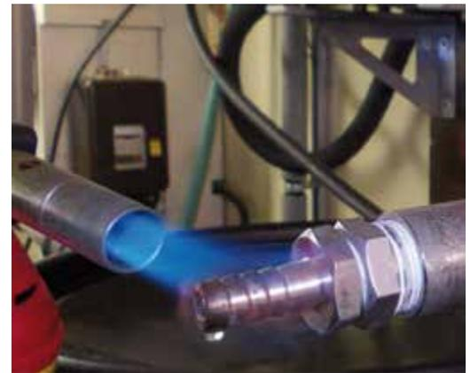
Sterilisierung des Wasseranschlusses
